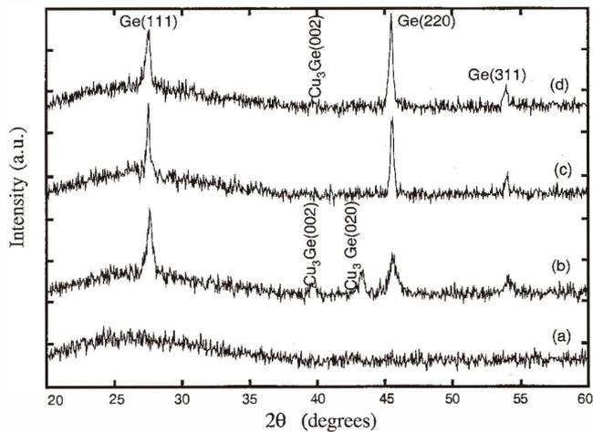
Fig. 10. XRD spectra for (a) a-Ge (b) MIC a-Ge (c) p-Ge and (d) MIC p-Ge samples.
